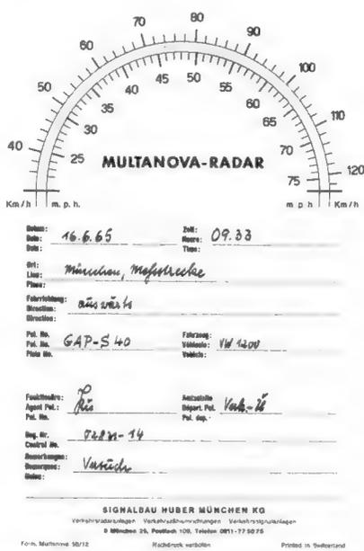
Bild 8. Meßprotokoll des Multanova-Radars. Die gemessene Geschwindigkeit wird im Original durch einen roten Kreisbogen ausgedruckt. Sie ist hier durch ein Graueraster gekennzeichnet
