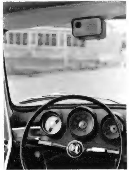
Bild 4. Der Radarwarner soll am besten an die Sonnenblende angeklammert werden, damit er nicht durch die Karosserie abgeschirmt wird
