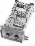
**WS 88 quartzgesteuerter 4-Kanal-Sende-Empfänger**, mit 15 Rö.: 3 A 4, 6 x 1 L 4, 4 x 1 T 4, 1 S 5, 2 x 1 A 3 sowie 4 Vakuum-Steckquarze. Betriebsspannung: 1,5 V Heizung, 90-V-Anode, HF-Leistg.: 0,35 mW. Maße: 140 x 90 x 240 mm, Gewicht: 2,7 kg, feuchtigkeitsgeschützt, Frequ.-Ber: 38 bis 40 MHz, einfacher Umbau auf 10 m möglich, kpl. mit Schaltplan und Sendeeingangstaste, mit orig. Sprechgerät bestehend aus Kopfhörer und Mikrofon **58.50**
